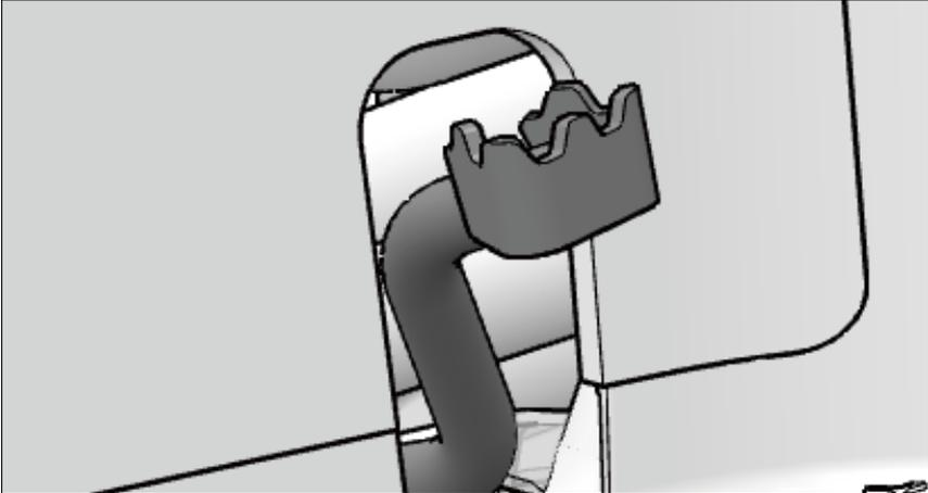
Das Bremspedal der Fußbremse befindet sich auf der rechten Fahrzeugseite. Die Fußbremse steuert den vorderen und hinteren Bremskreis und damit die Vorder- und Hinterachse. Die Fußbremse muss während des Betriebs des Fahrzeugs als primäres Bremssystem verwendet werden und wird daher auch als Betriebsbremse bezeichnet.
