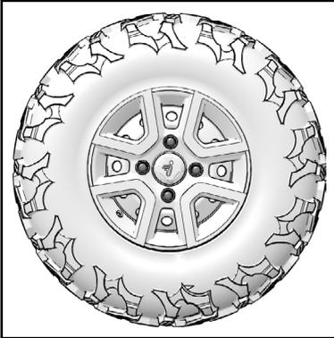
Anzugsdrehmoment der Radmuttern: .... 70-80 Nm
